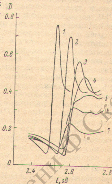
Рис. 2. Спектры пленок твердых растворов \text{PbVg}_2\text{J}_{2x} в области существования гексагональной фазы.
