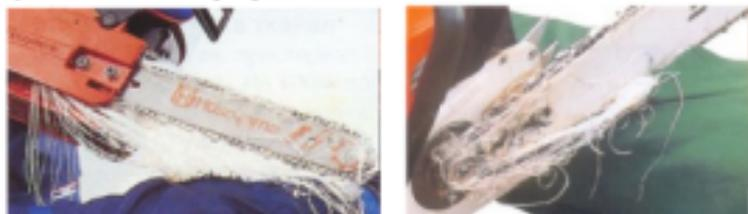
Рис. 5.41. Разрез верхнего слоя защитной одежды
