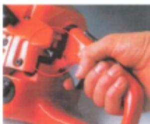
Рис. 5.32. Комбинированный рычаг переключения
