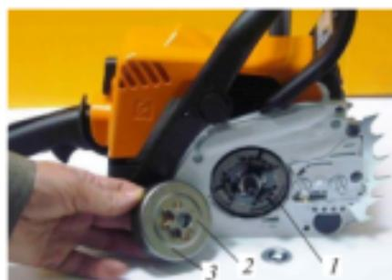
Рис. 5.18. Основные части муфты сцепления: 1 – ведущая часть муфты; 2 – ведущая звездочка; 3 – ведомая часть муфты
