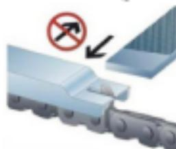
Рис. 6.26. Стачивание ограничителя пропила
