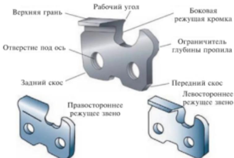
Рис. 5.27. Устройство режущего звена
