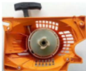
Рис. 5.13. Общий вид стартера бензопилы
