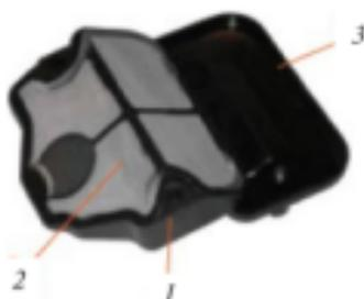
Рис. 5.8. Воздушный фильтр: 1 – пластиковый каркас; 2 – сетка; 3 – пластиковое основание
