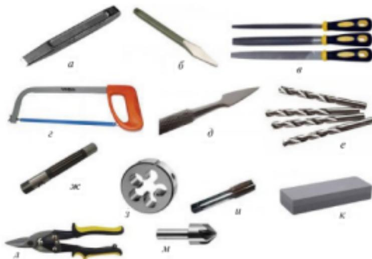
Рис. 3.10. Режущие инструменты: а – зубило; б – крейцмейсель; в – напильники; г – ножовка; д – шабер; е – спиральные сверла; ж – развертка; з – плашка; и – метчик; к – абразивный брусок; л – ножницы по металлу; м – зенкер
