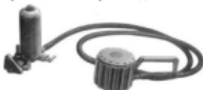
Рис. 8.3. Общий вид гидравлического домкрата ДГМ-16
