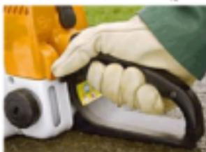
Рис. 6.7. Перевод комбинированного рычага в положение холодного запуска
