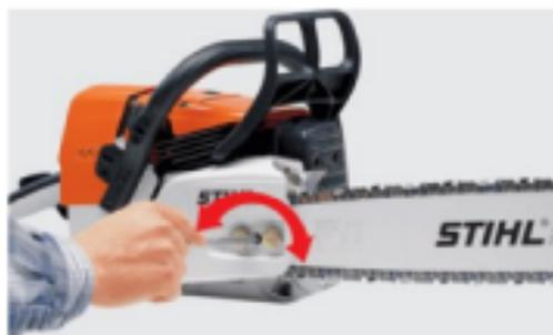
Рис. 5.23. Натяжение пильной цепи
