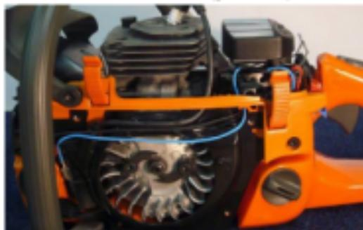
Рис. 5.10. Система зажигания бензопилы
