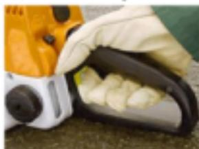
Рис. 6.6. Разблокировка рычага подачи топлива
