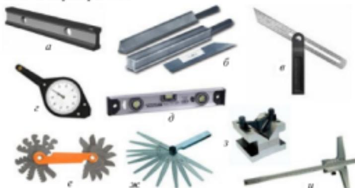
Рис. 3.20. Специальные измерительные и контрольные слесарные инструменты: а – линейка проверочная; б – линейки проверочные лекальные; в – малка; г – курвиметр; д – уровень; е – резбомер; ж – щуп; з – призма проверочная; и – штангенглубиномер
