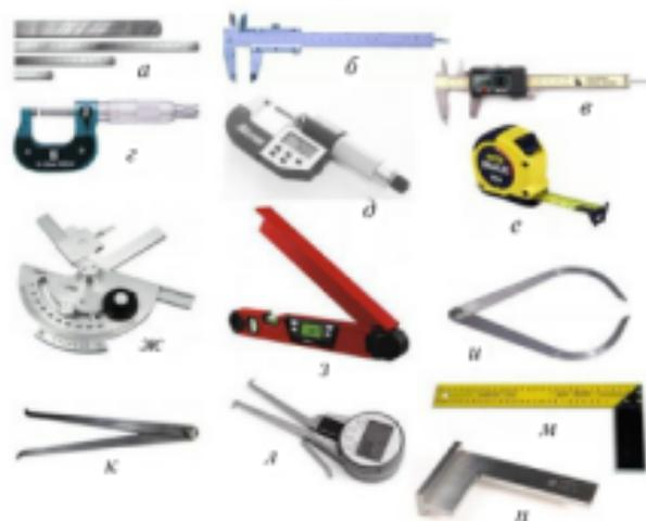
Рис. 3.14. Универсальные измерительные и контрольные слесарные инструменты: *а* – измерительная линейка; *б* – универсальный штангенциркуль; *в* – универсальный штангенциркуль с электронным индикатором; *г* – микрометр; *д* – микрометр с электронным индикатором; *е* – измерительная рулетка; *ж* – угломер; *з* – угломер с электронным индикатором; *и* – кронциркуль; *к* – нутромер; *л* – нутромер с электронным индикатором; *м* – угольник слесарный; *н* – угольник слесарный поверочный
