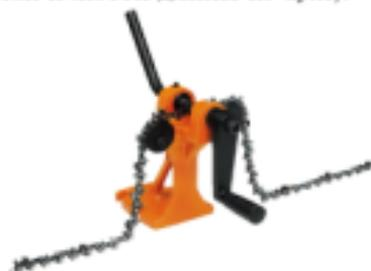
Рис. 6.22. Заклепочный станок
