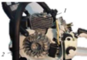
Рис. 5.9. Элементы системы охлаждения
