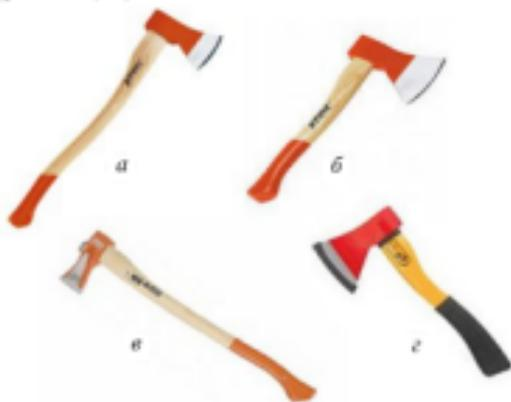
Рис. 4.5. Формы топоров: а – лесорубный; б – сучкорубный; в – колун; г – для тески древесины
