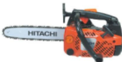
Рис. 4.3. Внешний вид «одноручной» пилы
