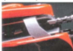
Рис. 5.38. Улавливатель пильной цепи
