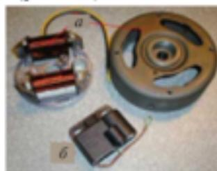
Рис. 5.11. Основные части магнето: а — маховик с магнитной системой; б — трансформаторный узел
