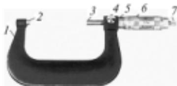
Рис. 3.17. Устройство микрометра
