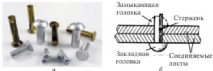
Рис. 3.23. Заклепки: *а* – общий вид заклепок; *б* – строение заклепки
