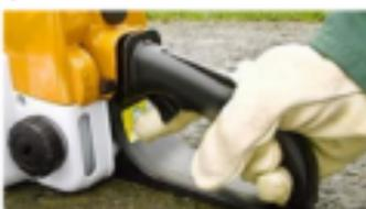
Рис. 6.13. Перевод двигателя в положение холостого хода
