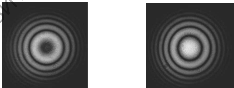
Рисунок 3 – Профиль интенсивностей интерференционных пучков в проходящем поле Расстояние между центрами пучков линейно увеличивалось по мере
