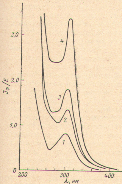
Рис. 3. Динамика изменения спектров фотопроводимости ( -35^\circ \text{C} ), измеренных при одном положении поляроида (1, 2, 3) и при перпендикулярном первоначальному (4).
