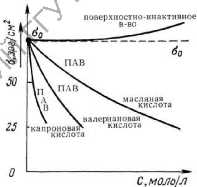
Рис. 8.1 – Зависимость поверхностного натяжения от концентрации водных растворов  $\sigma = f(C)$ .
