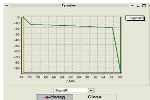
Рисунок 2 – График зависимости  $\sigma_r^{(k)}$  от  $r$
