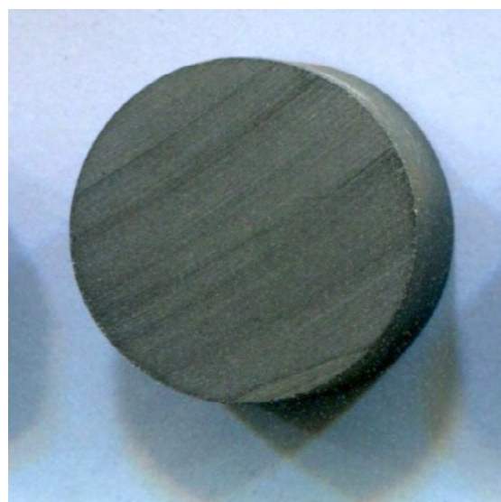
Рис. 2. Спрощена схема комірki високого тиску для отримання надтвердої кераміки (а) та загальний вигляд виготовленої керамічної пластини (б)
