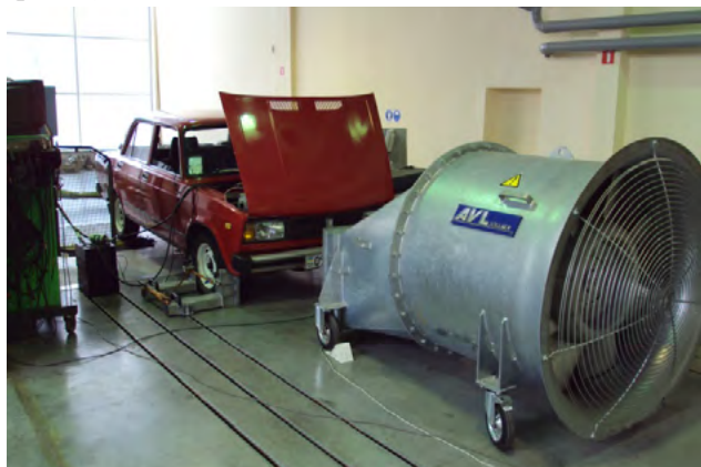
Рис. 3. Автомобіль під час виконання їздового циклу
