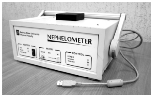
Рис.1 – Лазерный нефелометрический анализатор (общий вид)
