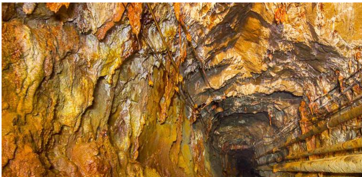
Рисунок 10 – Минералообразование на стенках горных выработок [6, с изменениями]
