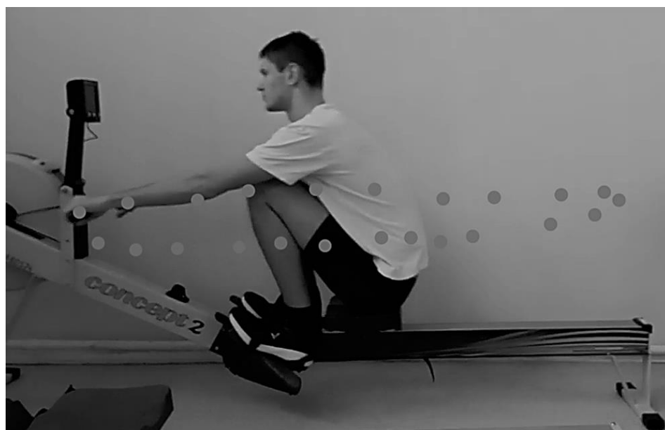
Рисунок 2 – Траектория ОЦМт гребца в цикле гребка на гребном эргометре: восстановление представлено нижней частью, а тяга – верхней частью кривых
