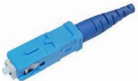
Разъем типа SC широко используется как для одномодового, так и для многомодового волокна. Относится к классу разъемов общего пользования. В разъеме используется механизм сочленения «push-pull», при котором соединитель защелкивается. Может объединяться в модуль, состоящий из нескольких разъемов. В этом случае модуль может использоваться для дуплексного соединения (одно волокно которого используется для передачи в прямом, а другое в обратном направлениях).
