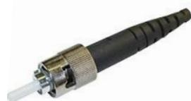
Разъем типа ST использует быстро сочленяемое байонетное соединение, которое требует поворота разъема на четверть оборота для осуществления соединения/разъединения. Применяется как для одномодового, так и для многомодового кабеля. Самый дешевый разъем
