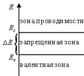
Рисунок 20 - Схематическое изображение энергетических зон твердого тела
