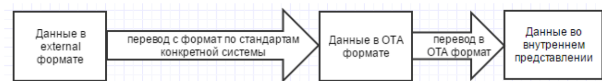
Рисунок 2 – Процесс трансформаций данные при получении их от внешней системы
