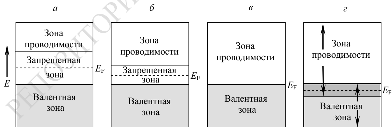
Рисунок 1.11 – Схема энергетических зон в диэлектриках (а), полупроводниках (б), металлах (в) и полуметаллах (г). E_F – уровень Ферми
