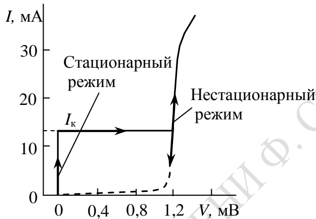
Рисунок 2.11 – Вольтамперная характеристика туннельного контакта Sn–Sn при температуре 1,4 К.
