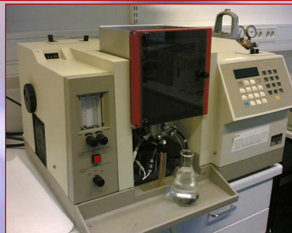
Прибор для эмиссионного и атомно-абсорбционного спектрального анализа
