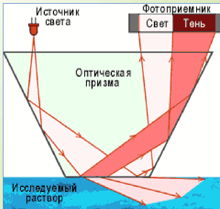
Оптическая схема рефрактометра Хеш
