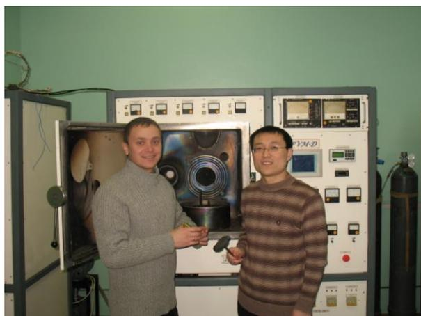
Установка для синтеза нанокomпозиционных покрытий на основе углерода и плазмы импульсного катодно-дугового разряда. На фото (слева направо): научный сотрудник Д.Л. Горбачев; аспирант Чжоу Бин
