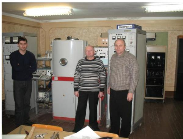
Установка для формирования оптических покрытий.
