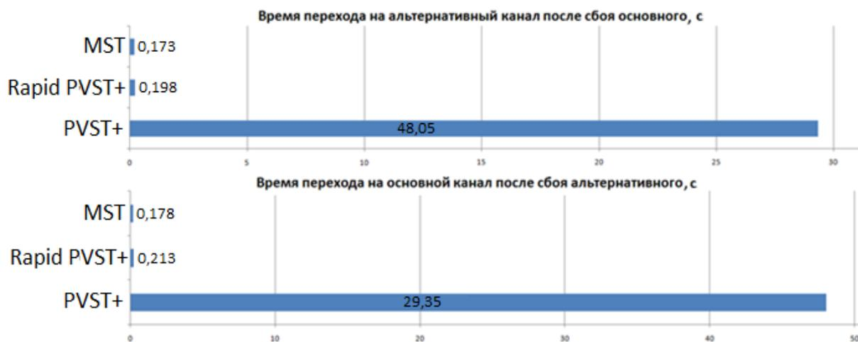
Рисунок 1 – Сравнение временных характеристик восстановления канала связи в протоколах PVST+, Rapid PVST+, MSTP
