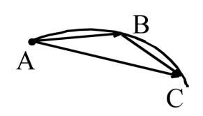
Если положение точки в декартовой системе координат задано радиус-вектором, то перемещение можно определить как разность радиус векторов, характеризующих конечное (2) и начальное (1) положения точки, движущейся в течение промежутка времени  $\Delta t = t_2 - t_1$
