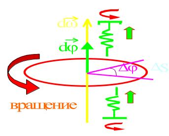
Найдем связь между линейной скоростью  $v_{1}$ точки, находящейся на расстоянии **R** от оси и угловой скоростью ω:
