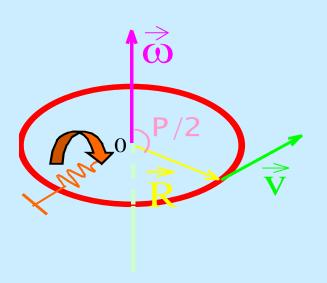
Направление скорости V определяется правилом правого винта (буравчика). Винт располагаем перпендикулярно оси и вращаем от ω к R.
