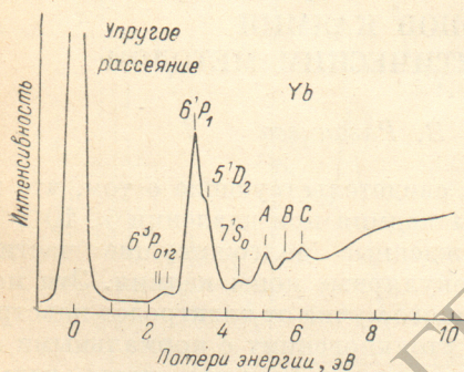
Рис. 1. Спектр электронов, рассеянных атомами иттербия.
