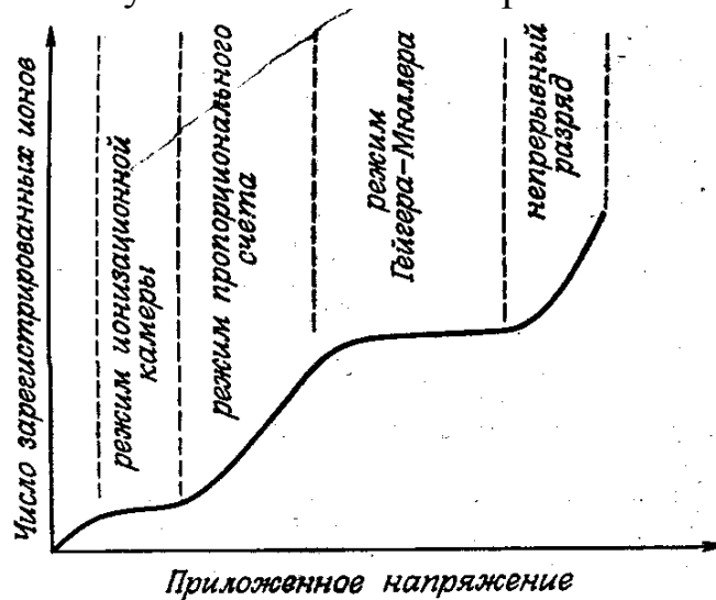
Рис.2 Влияние приложенного напряжения на поток ионов
