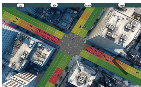
Рисунок 4а – Модель перекрестка в процессе имитации (2D)
