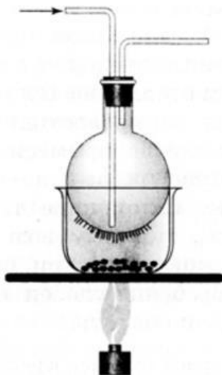
Рисунок 11 – Установка для проведения возгонки при атмосферном давлении
