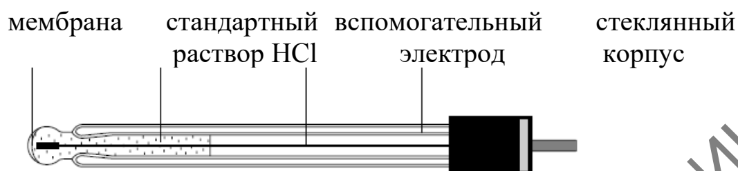
Рис. 2.4. Устройство стеклянного электрода
