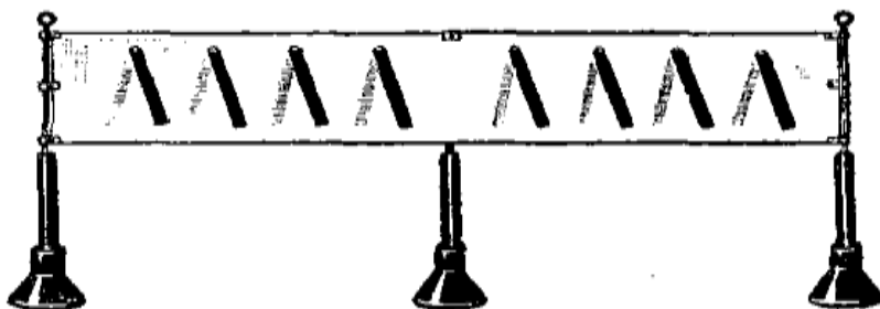
Рис. 4. Равномерное распределение зарядов на плоской поверхности.
