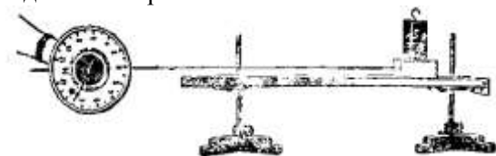
Рис. 1. Измерение силы трения покоя и скольжения
