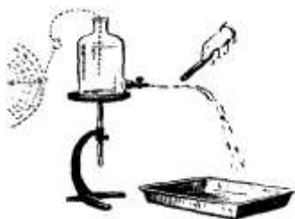
Рис. 2. Притяжение струи воды к наэлектризованной палочке.
