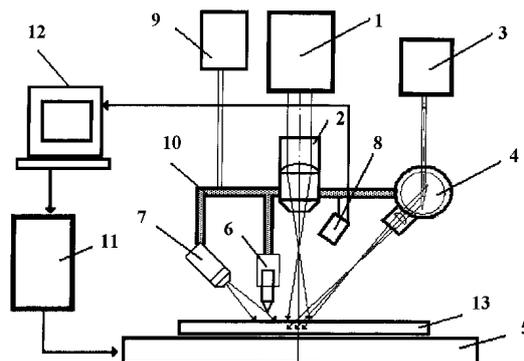
Полезная модель относится к оборудованию для лазерной резки хрупких неметаллических материалов методом управляемого лазерного термораскалывания и может быть использована в электронной, стекольной и авиационной промышленности для прецизионного разделения следующих хрупких неметаллических материалов: различных типов стекла, различных типов керамики, кремния, сапфира, арсенида галлия и карбида кремния.
