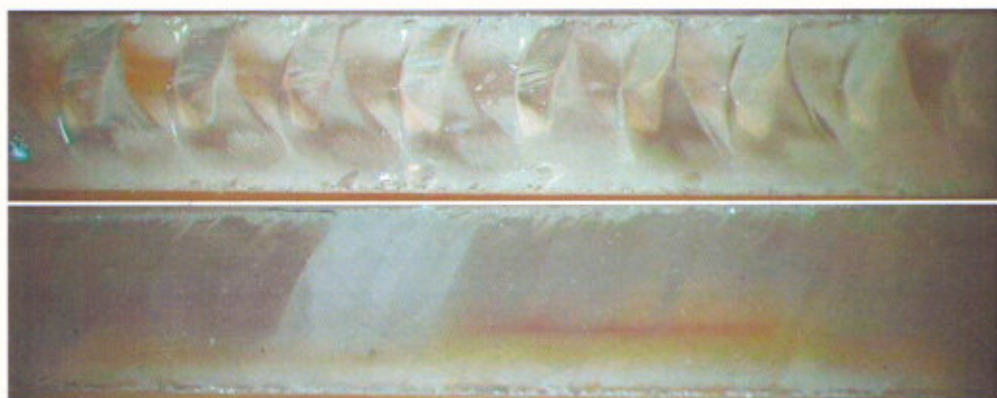
Рис. 6.6. Вид торцов кварцевых пластин, разделенных методом управляемого лазерного термораскалывания
