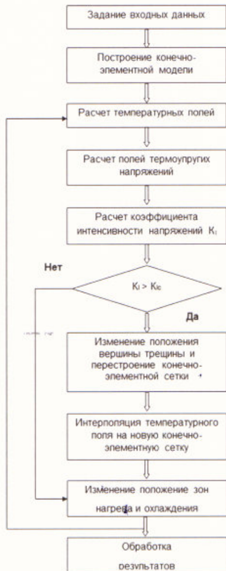
Рис. 6.11. Алгоритм конечно-элементного моделирования лазерного раскалывания кварцевого стекла
