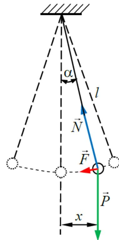
Следовательно, движение математического маятника описывается дифференциальным уравнением гармонических колебаний, то есть происходит по закону  $x = A \cdot \cos(\omega t + \phi)$  с частотой и периодом, соответственно:
