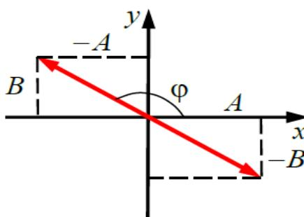
Результатирующее колебание является гармоническим колебанием с частотой  $\omega$  и амплитудой  $\sqrt{A^2 + B^2}$  и совершается вдоль прямой, составляющей с осью  $x$  угол  $\varphi = \arctg(B/A) \cos m\pi$ . Такие колебания называются **линейно поляризованными колебаниями**.
