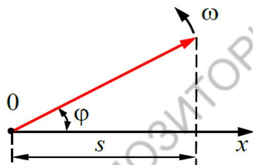
Гармонические колебания изображаются графически **методом вращающегося вектора амплитуды** или **методом векторных диаграмм**.
