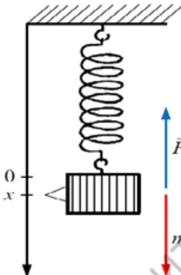
Сравнивая это уравнение с уравнением движения гармонического осциллятора  $\ddot{s} + \omega^2 s = 0$ , мы видим, что пружинный маятник совершает колебания по закону  $x = A \cdot \cos(\omega t + \varphi)$  с циклической частотой и периодом
