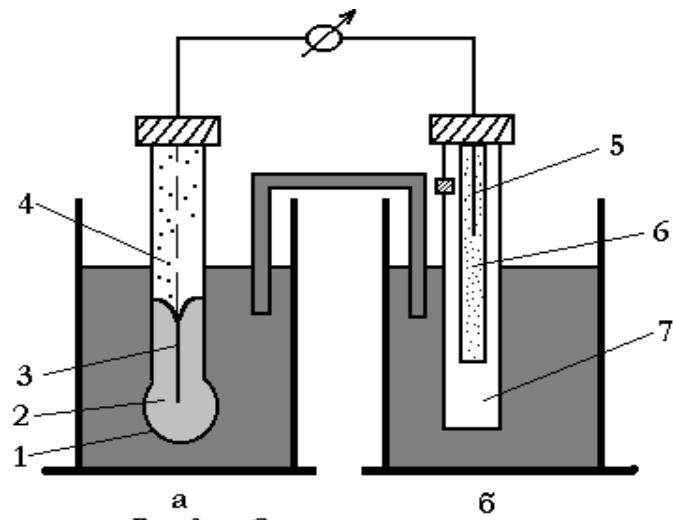
Рис.3. Схема гальванического элемента.
