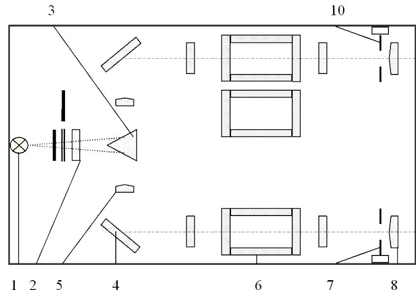
Рис. 1 Оптическая схема прибора ФЭК – 56
