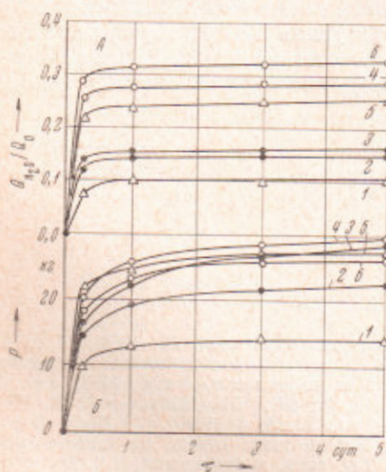
Рис. 1. Давление набухания (B) и водопоглощение (A) цементного камня: 1 — В/Ц = 0,3; 4 — В/Ц = 0,5 — паренные; 2 — В/Ц = 0,3; 5 — В/Ц = 0,5 — нормального твердения в течение 28 суток; 3 — В/Ц = 0,3; 6 — В/Ц = 0,5 — нормального твердения в течение 7 суток
