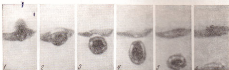
Рис. 3. Капиллярное отражение капли от границы раздела. 1-й кадр — то же, что рис. 2, кадр 6; 2, 3, 4-й кадры — движение капли после отражения; 5-й кадр — начало взаимодействия с дном сосуда при отраженном движении; 6-й кадр — сплющивание капли при ударе о дно сосуда. Частота съемки 12 кадров/сек
