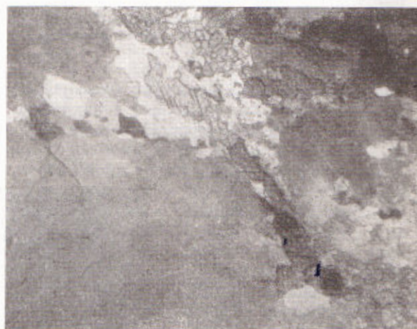
Рис. 1. Замещение лабрадора мелкозернистыми агрегатами плагноклаза второй генерации. 30X. Без анализатора
