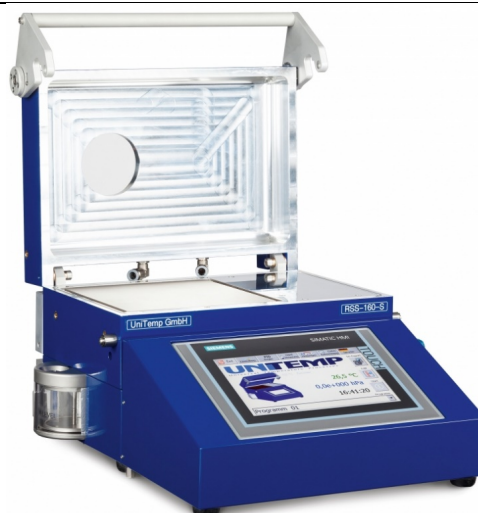
Рисунок 4.1 – Малогабаритная вакуумная печь оплавления RSS-160-S ф. UniTemp
