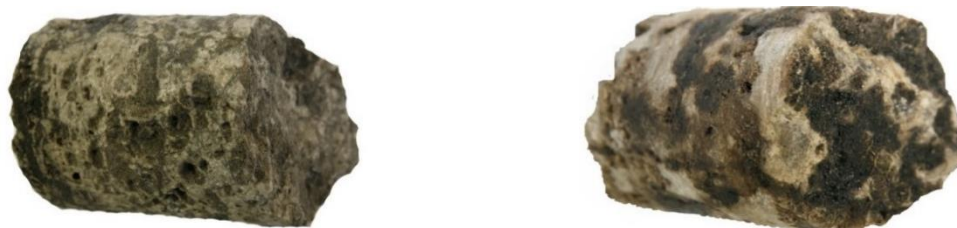
Рисунок 2 – Образцы керна материала: доломит пятнистый (слева); доломит порово-кавернозный, нефтенасыщенный (справа).
