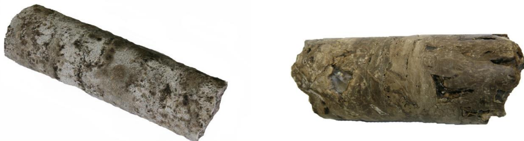
Рисунок 1 – Образцы керна материала. Известняк водорослевый (слева). Известняк органогенно-водорослевый (справа)
