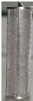
Рисунок 12 – Пример цилиндрического Pt-марлевого электрода для кулонометрии с контролируемым потенциалом. Показанный здесь электрод имеет диаметр 13 мм и высоту 48 мм, и его изготавливают из проволоки Pt диаметром приблизительно 0,15 мм. Поверхность электрода имеет 360 отверстий / см<sup>2</sup> и общую площадь поверхности около 40 см<sup>2</sup>
