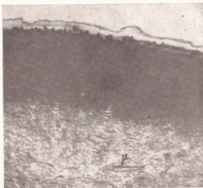
Рис. 1. Электронная микрофотография поперечного среза двукратно привитого полипропиленового волокна (58 в. ч. полиакриловой кислоты и 10 в. ч. поливинилиденхлорида на 100 в. ч. полипропилена). Промежуточный слой полиакриловой кислоты контрастирован солью свинца
