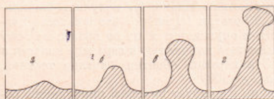
Рис. 1. Образование термика в слое анилина, подогреваемого снизу, а, б — слой в период накопления тепла; в, г — образование — термика при конвективной разрядке
