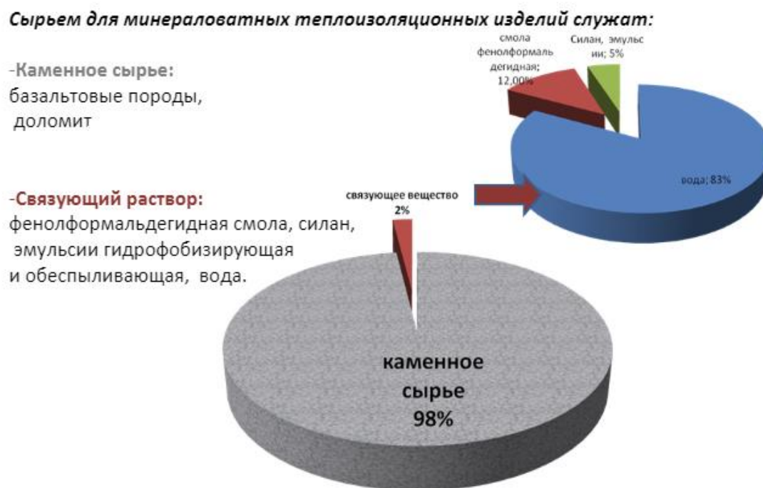
Рисунок 1 – Состав минераловатной плиты
