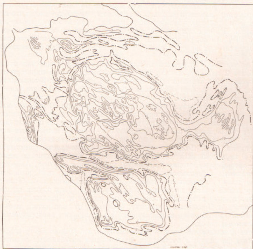
Рис. 2. Схема изолиний магнитного поля \Delta z п-о Турий (мг)
