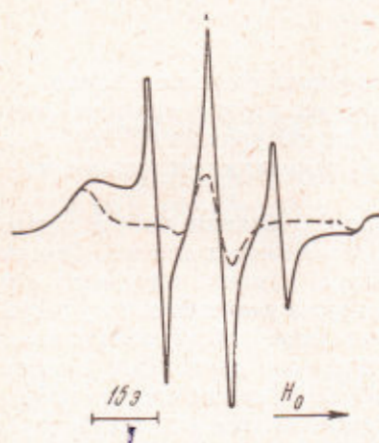
Рис. 3. Спектр э.п.р. радикал-зонда 1 в термоэластопласте при 20°С. Пунктиром выделен спектр, соответствующий «замороженным» радикалам
