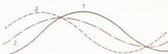
Рис. 3. Поведение двух взаимодействующих подсистем X и Y по закону синуса и косинуса при работе модели в режиме автоколебаний. 1 - x = \sin \omega t , 2 - y = \cos \omega t , 3 - A = C_1 \sin \omega t + C_2 \cos \omega t
