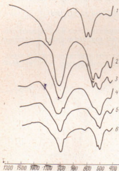
Рис. 3. И.-к. спектры продуктов обжига образцов системы \text{BaO} - \text{Nd}_2\text{O}_3 - \text{SiO}_2 . 1 — \text{Ca}_5(\text{PO}_4)_3\text{F} ; 2 — \text{BaNd}(\text{SiO}_4)_2\text{O} ; 3 — 4\text{BaO} : 3\text{Nd}_2\text{O}_3 : 6\text{SiO}_2 ; 4 — 6\text{BaO} : 2\text{Nd}_2\text{O}_3 : 6\text{SiO}_2 ; 5 — 8\text{BaO} : \text{Nd}_2\text{O}_3 : 6\text{SiO}_2 ; 6 — 5\text{BaO} : 3\text{SiO}_2
