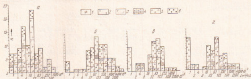
Рис. 1. Гистограмма рядов распределений компонентов газов, включенных в кристаллические породы. а — метан, б — этан, в — пропан, г — водород. 1 — гнейсы, 2 — граниты, 3 — габброиды, 4 — мраморы, 5 — щелочные породы, 6 — рудоносные метасоматиты
