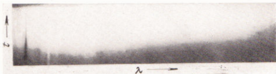
Рис. 4. Спектрофотохронограмма яркости ударной волны через отверстие в мишени, спрессованной из порошка \text{KCl} ( \lambda = 400 \div 600 мμ, прочерчена реперная линия \lambda = 435,8 мμ от ртутной лампы)
