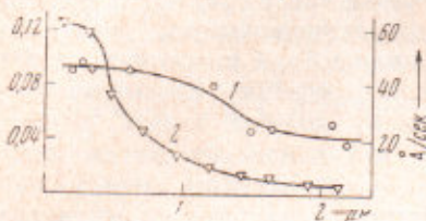
Рис. 2. Распределение кристаллов по размеру (2) и скорости роста кристаллов серебра (1) в зависимости от расстояния от кристалла оксалата серебра
