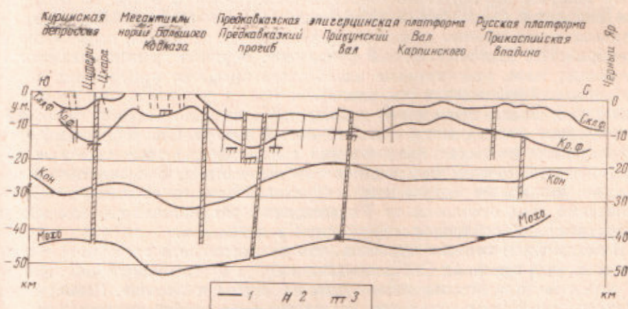
Рис. 3. Геолого-геофизический разрез по линии Волгоград — Нахичевань, 1 — сейсмические границы, 2 — зоны нарушения корреляции сейсмических волн, 3 — верхние крошки магнито-возмущающих масс. Границы поверхностей: С.ф. — складчатого фундамента, Кр. ф. — кристаллического фундамента, Кон — Конрада, Мох — Мохоровичича
