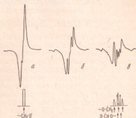
Рис. 4. Дифференциальное насыщение \gamma -облученного при 77° К ПОМ при разных токах с.в.ч. детектора (ма): а — 0,05, б — 0,8, в — 2,0. Относительное усиление при регистрации спектров 1:6:15; масштаб развертки поля 10 эрст/мм
