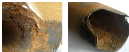
Рисунок 1 – Эрозионная коррозия НКТ, эксплуатируемой в условиях добывающей скважины нефтяного месторождения Припятского прогиба
