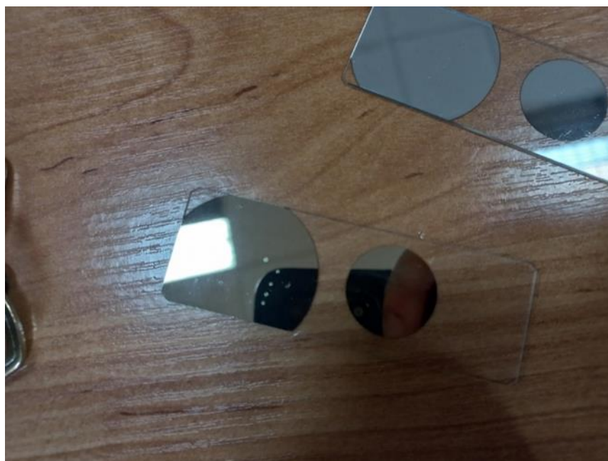
Рисунок 2 – Алюминиевое и медное покрытия после разрушения лазерным излучением
