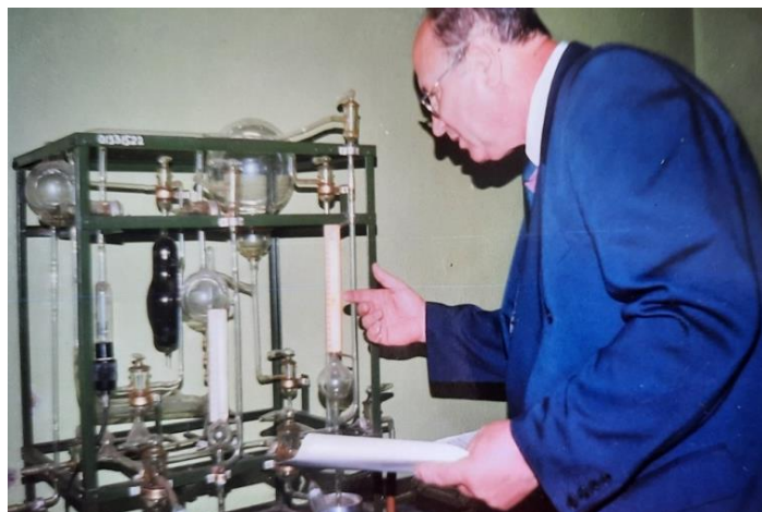
Рисунок 1 – В. Я. Матюшенко у лабораторной установки для исследования водородного изнашивания металлов
