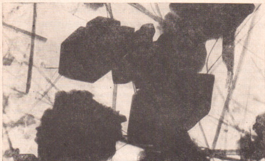
Рис. 1. Электронмикроскопическая фотография таблитчатых кристаллов антигорита и волокнистого хризотила, полученных при гидротермальной обработке оливина. 24\,000\times
