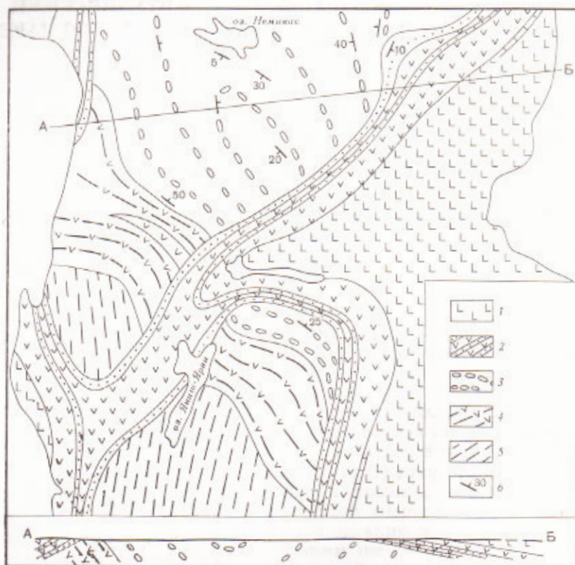
Рис. 2. Схематическая геологическая карта района озер Немикас — Янишярви. 1 — габбро-диабазы, 2 — песчаники и основные эффузивы ятулия, 3 — грайитные и полимиктовые конгломераты сариолия, 4 — эффузивные метадиабазы, 5 — толщи кристаллических сланцев, 6 — элементы залегания слоистости
