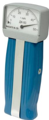
Рисунок 2 – Ручной динамометр [4]
